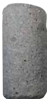
なおしたる AR-M 28日間 15% 硫酸浸漬後 質量変化率：-20.9%
